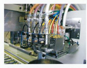
▲インキ吐出ガン 沈降防止のため、循環機構付。 ノズルの乾燥を防止するフタ も取付可能。
